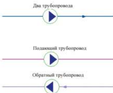
Рисунок 2.17. Сверху: однолинейное изображение сети, снизу- внутреннее представление.
