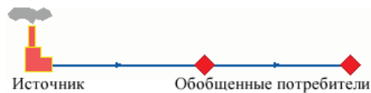
Рисунок 2.11. Сеть с обобщенными потребителями
