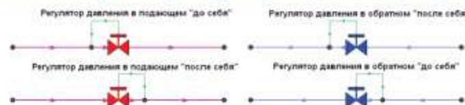
Рисунок 2.34. Изображения регуляторов давления “до себя” и “после себя”
