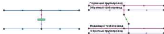
Рисунок 2.28. Слева: однолинейное изображение сети, справа: её внутреннее представление
