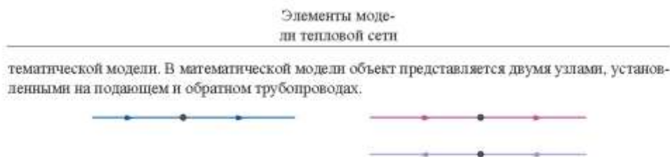
Рисунок 2.12. Слева однолинейное изображение узла, справа: внутреннее представление
